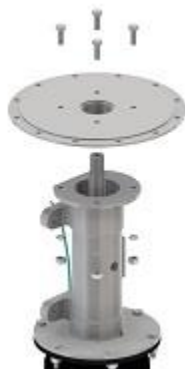
Figura 28: prendendo a tampa da bomba ao mancal.
