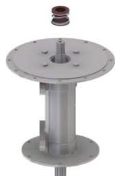
Figura 13: remoção do selo mecânico (parte móvel).
