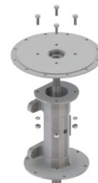
Figura 14: remoção do selo mecânico (parte fixa).
