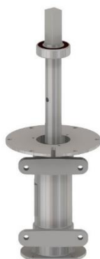
Figura 21: inserção do eixo no mancal.
