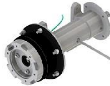
Figure 26: travamento do eixo para auxílio no aperto das porcas.
