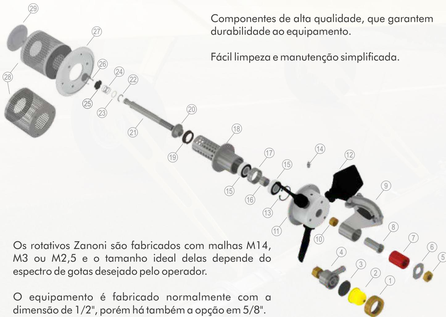
Os rotativos Zanoni são fabricados com malhas M14, M3 ou M2,5 e o tamanho ideal delas depende do espectro de gotas desejado pelo operador.
